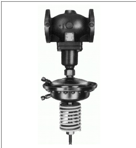
Le régulateur AFPA/VFG2 est une vanne autonome de régulation de pression différentielle. C'est une vanne de décharge montée généralement en décharge après la pompe, elle s'ouvre à augmentation de pression différentielle.
