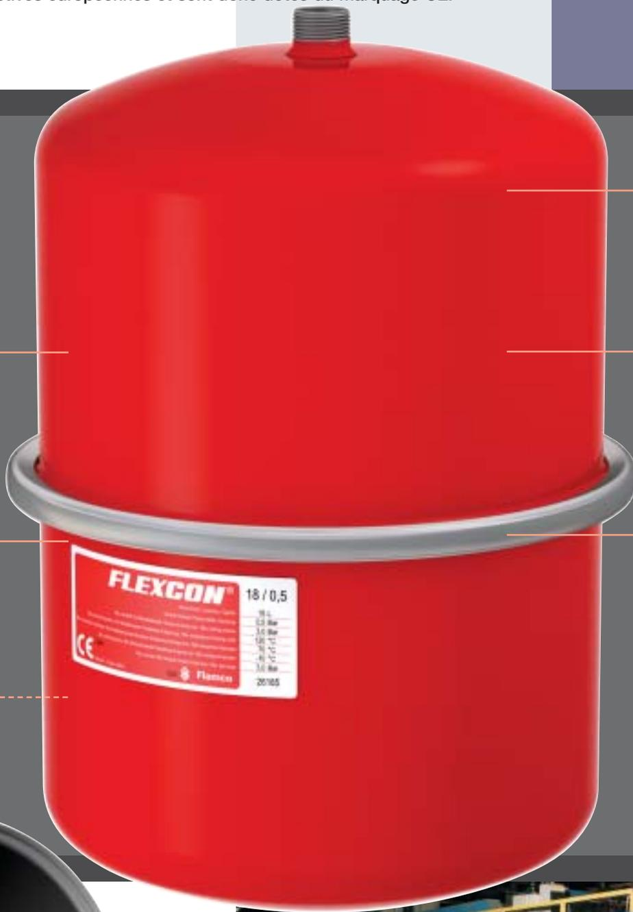
La paroi extérieure du vase est laquée avant l'assemblage, et non après. Cela permet d'éviter le risque de corrosion sur l'anneau de sertissage!
